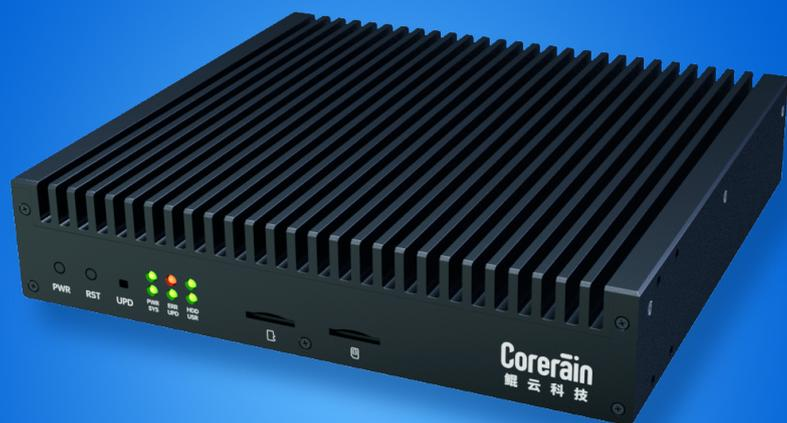
鲲云星空N430P边缘小站是一款面向边缘应用的智能计算盒子，搭载鲲云第四代数据流AI芯片CAISA 430，可提供16TOPS峰值算力。基于全球领先的数据流架构，星空N430P边缘小站可最大化利用芯片资源，实测性能高，最高支持32路高清视频解码和实时智能分析，搭配3×8核ARM Cortex-A55处理器，强劲性能可支撑用户实现多元复杂的系统应用和定制化产品需求，可广泛应用在智慧城市、智慧交通、智慧能源、智慧安监等领域。
